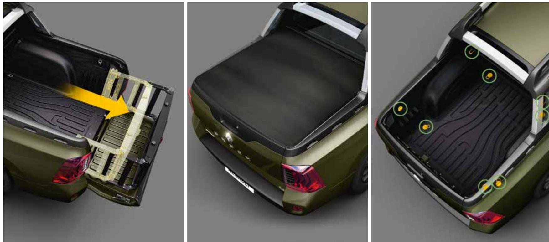
**Grande idée que cette benne à extension (en accessoire)!** Elle permet d'accroître d'un tiers le volume de chargement (683l + 306l). Une fois repliée, l'extension sépare en deux l'espace disponible, qui peut être facilement recouvert par une bâche amovible. Huit anneaux de fixation repliables, supportant chacun jusqu'à 50 kg de charge, facilitent l'arrimage des objets transportés.
